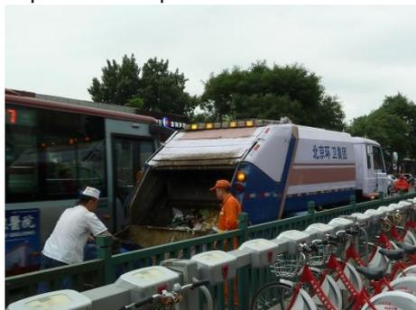
**Figura 10: compattatore caricato manualmente**
